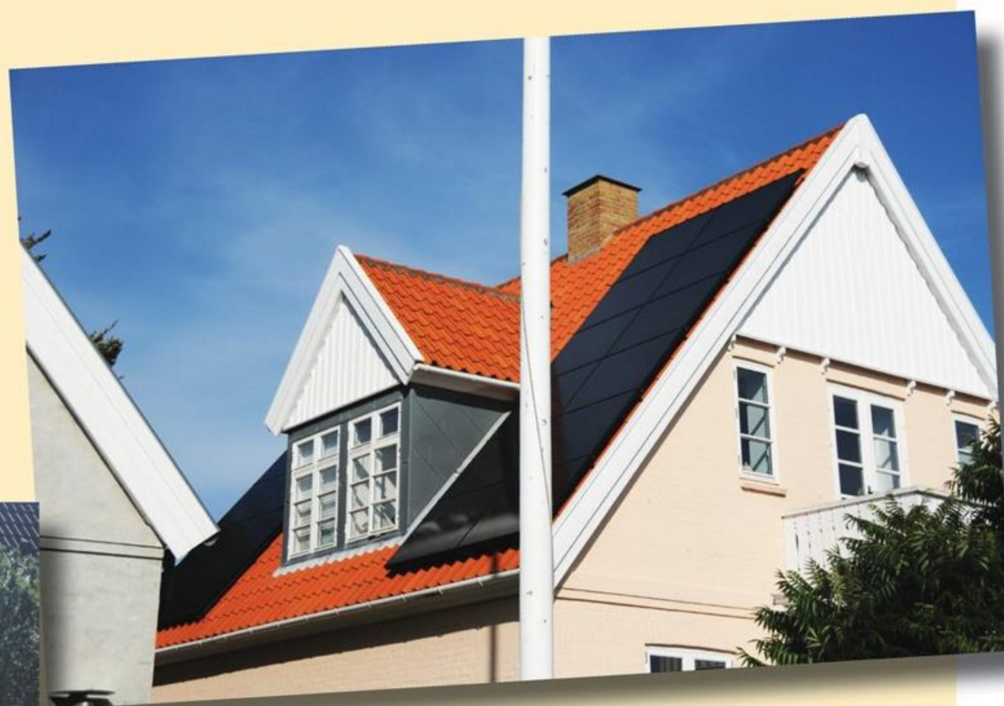
Fig. 15. Skygger fra flagstang, kvist og nabohus.
