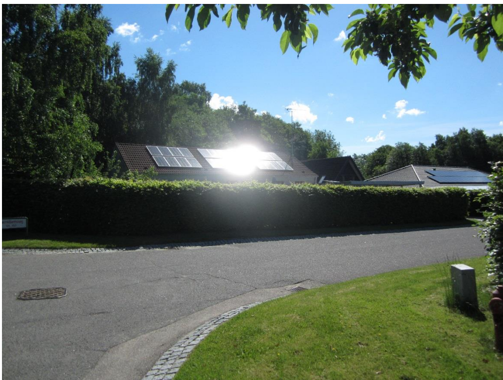
Fig.1 Eksempel på blænding fra et anlæg som vender mod vest sydvest. Taget 5. juni formiddag.[TI]
